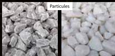
Appliquées en surface, elles s'intègrent dans la peau de béton.
