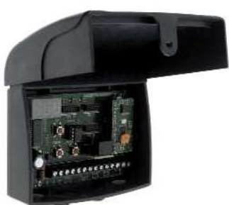
Récepteur radio pour télécommander une porte de garage ou une lumière
